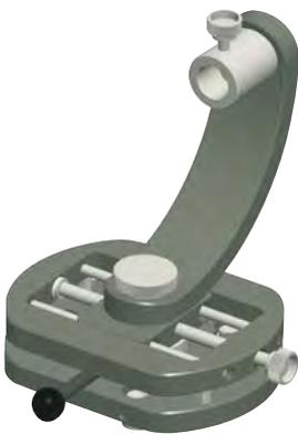
Mit Hilfe des Dreh- und Schwenkadaptors kann der Laser T330 in seiner Lage verändert werden. Dies ermöglicht eine horizontale, vertikale oder auch freie Ausrichtung der Laserebene und des Laserstrahls im Raum. Neben der Schwenkmöglichkeit kann der Laser auch exakt parallel verschoben werden, was bei der Einrichtung des Lasers auf eine Referenzlinie sehr hilfreich ist.
