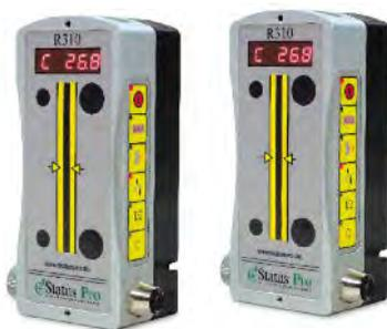
Der R310 misst die Position des rotierenden Laserstrahls wie eine Messuhr den Abstand von dem Werkstück zur Referenz. Der Strahl bildet eine ganze Referenzebene und nicht nur eine Linie wie ein Draht. Der R310 hat eine Reichweite von bis zu 80 Metern, ein Display und eine Tastatur zur vollständigen Steuerung auch ohne Software. Zur Softwareanbindung optional mit Bluetooth zu erhalten.
