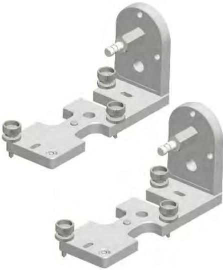
Universeller Adapter für R310 Receiver: Mit seinen drei verstellbaren Füßen kann der Boden- u. Wandhalter mit der eingebauten Libelle in Waage ausgerichtet werden und findet auf fast allen Untergründen festen Stand. Das 5/8 Zoll Gewinde ermöglicht eine Montage auf einem Vermessungsstativ, diverse Bohrungen und Langlöcher eine Befestigung an diversen Oberflächen.
